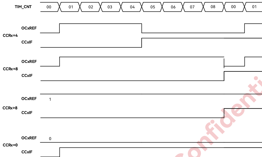
图 69 PWM 模式 1 波形 (ARR=8)
